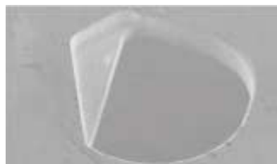
Рис. 3.18. Мікроерозійне фрезерування мікроформ 200 мікрон зі ступеневою порожниною глибиною 50 мкм
