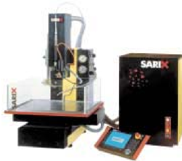
Рис. 3.17. Верстат для електро-ерозійної мікрообробки SX-100 фірма Sarix
