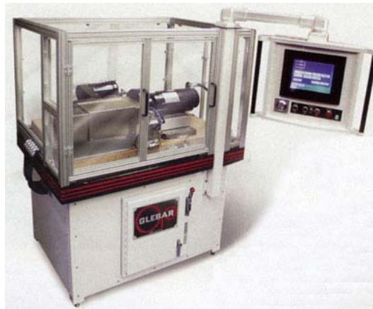
Рис. 3.9. Шестикоординатний верстат із ЧПУ САМ SXE-B фірми Glebar
