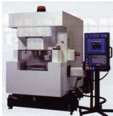
Рис. 3.6. Трьохкоординатний вертикальний обробний центр Nuper 2J фірми Makino
